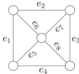
*Lösung:* Der Baum  $\hat{T} := \{e_5, e_6, e_7, e_8\}$  spannt  $G$  auf und induziert somit die Fundamentalbasis  $B := \{C_1, C_2, C_3, C_4\}$  mit  $C_1 := \{e_1, e_5, e_6\}$ ,  $C_2 := \{e_2, e_6, e_7\}$ ,  $C_3 := \{e_3, e_7, e_8\}$ ,  $C_4 := \{e_4, e_5, e_8\}$ . Das Gewicht eines minimalen Kreises in  $G$  ist 3. Da alle Kreise in  $B$  Gewicht 3 haben, ist diese Basis minimal.
