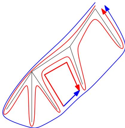
Läuft man die Knoten des Baumes in (Left-First-)Tiefensuchreihenfolge ab und betrachtet dabei Vorwärts- und Backtrackingkanten, entspricht dies genau zwei mal der Länge des Baumes. Die Pre-Order-Reihenfolge ist (nach der Dreiecksungleichung) höchstens kürzer. Also gilt Länge von  $K \leq 2 \cdot c(T) \leq 2 \cdot \text{OPT}$ . Folglich ist APPROX-TSP ein Faktor-2-Approximationsalgorithmus.
