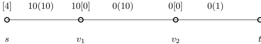
Führen Sie den Algorithmus von Goldberg und Tarjan auf diesem Graphen aus, um einen maximalen  $s$ - $t$ -Fluss zu berechnen. Die Initialisierung haben wir schon für Sie durchgeführt. Die Zahlen an den Kanten (ohne Klammern) bezeichnen den Wert des Präflusses, und die Zahlen in Klammern die Kapazität. Die Werte an den Knoten (ohne Klammern) bezeichnen den Flussüberschuss, und die Werte in eckigen Klammern die Distanz. Geben Sie die weiteren Schritte an:
