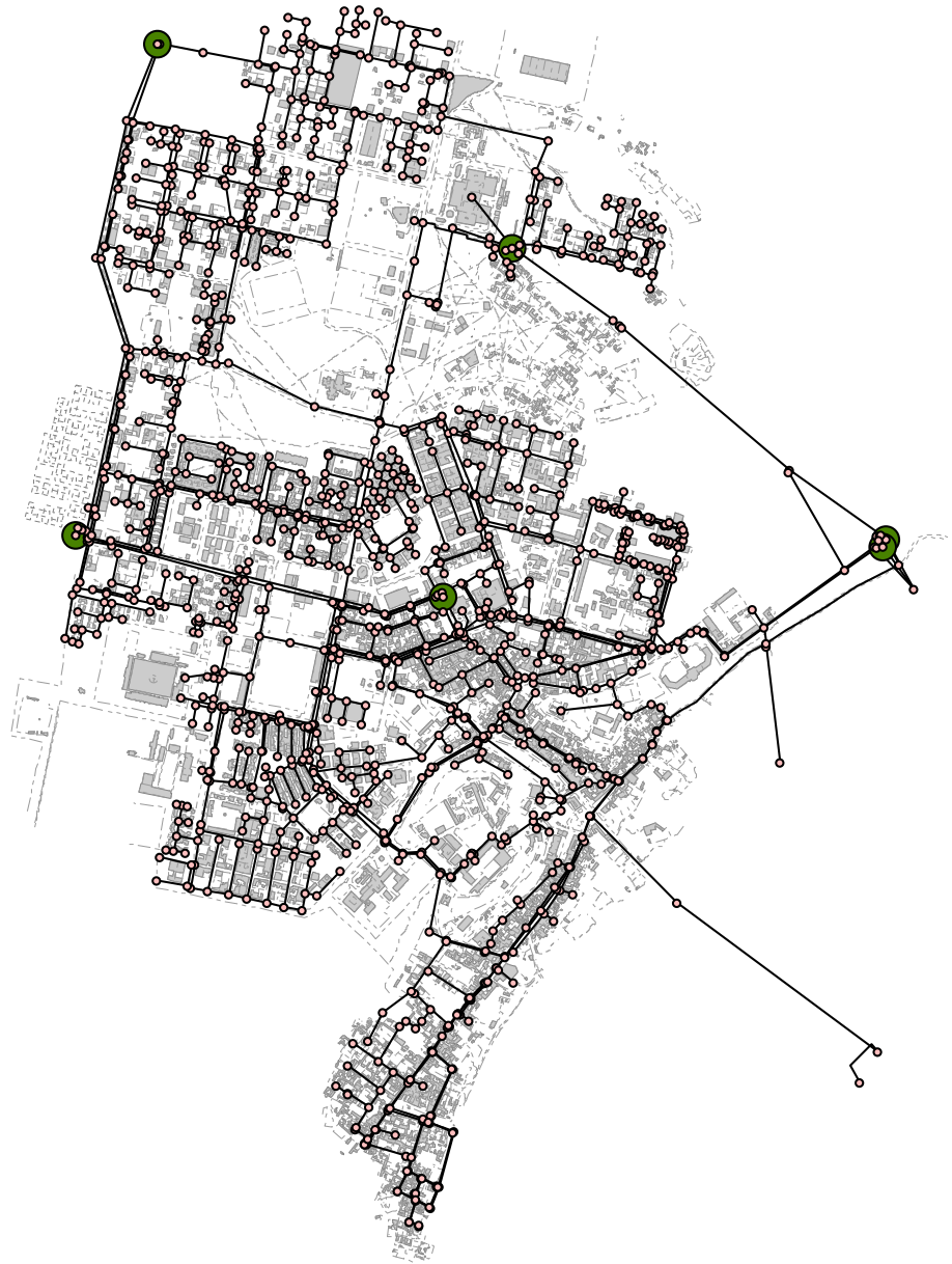
Abbildung 2.5 – Beispiel zur Modellierung des Wassernetzes einer Stadt in Nordafrika als Graph
