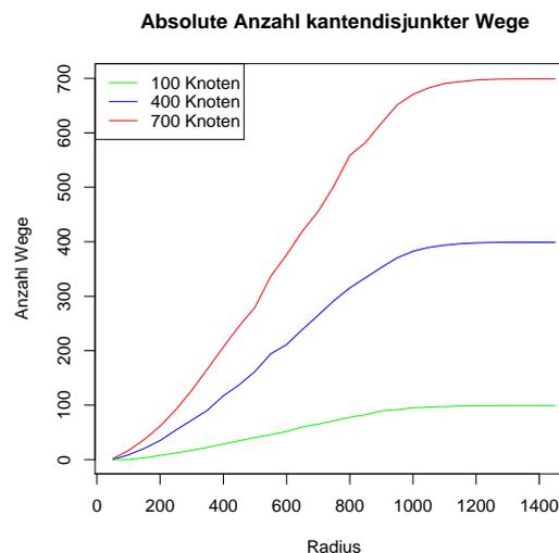
Abbildung 5.3: Die mittlere Anzahl kantendisjunkter Wege zwischen zufällig gewählten Start- und Zielknoten in zufälligen Graphen der Größen 100 Knoten (grün), 400 Knoten (blau) und 700 Knoten (rot).
