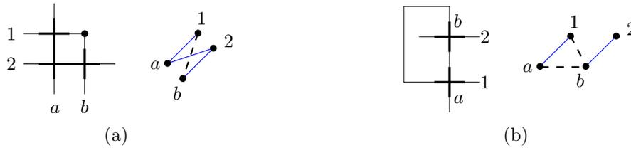
Abbildung 6.9: Verschwindende Vias (a) und Kanten, die sich bezüglich Vias unterschiedlich verhalten, im Clustergraph aber auf eine Kante abgebildet werden (b).
