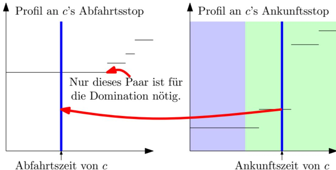
Teste ob das neue Paar über oder unter dem bereits existierenden ist.
