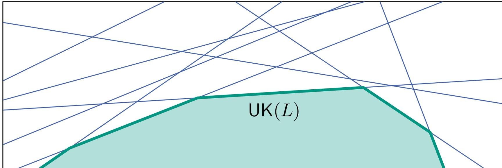
**Def.:** Für eine Menge  $L$  von Geraden ist die untere Kontur  $UK(L)$  von  $L$  die Menge aller Punkte aus  $\cup_{\ell \in L} \ell$ , die unterhalb aller Geraden aus  $L$  liegen.
