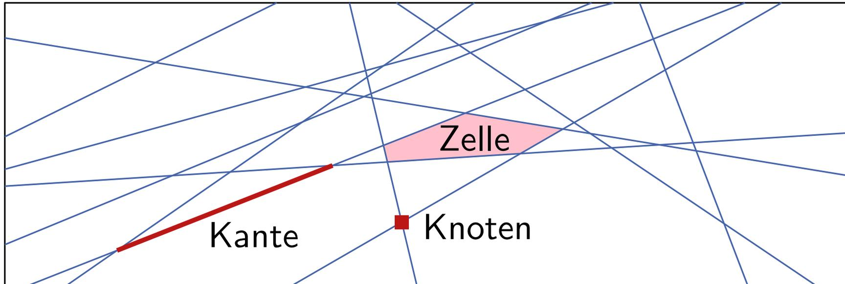
**Def.:** Eine Menge  $L$  von Geraden definiert eine Unterteilung  $\mathcal{A}(L)$  der Ebene (das **Geradenarrangement**) in Knoten, Kanten und Zellen (tlws. unbeschränkt).
