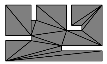
**Satz 1:** Jedes einfache Polygon mit n Ecken besitzt eine Triangulierung; jede Triangulierung besteht aus n-2 Dreiecken.
