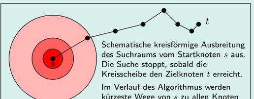
Schematische kreisförmige Ausbreitung des Suchraums vom Startknoten  $s$  aus. Die Suche stoppt, sobald die Kreisscheibe den Zielknoten  $t$  erreicht. Im Verlauf des Algorithmus werden kürzeste Wege von  $s$  zu allen Knoten innerhalb des Suchraums berechnet.
