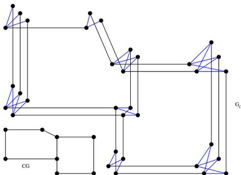
**Aufgabe:** Berechnen Sie an Hand einer Zweifärbung des Clustergraphen (z. B. der in Abb. 6.11 angegebenen) eine Zweifärbung des Konfliktgraphen (nach Festlegung der Repräsentanten). Bestimmen Sie die sich daraus ergebende Viareduktionsfunktion  $v_{\text{red}}$ , und lösen Sie die resultierende Instanz von MAX-VIA-REDUKTION. Welche Realisierung des Layouts ergibt sich dadurch?
